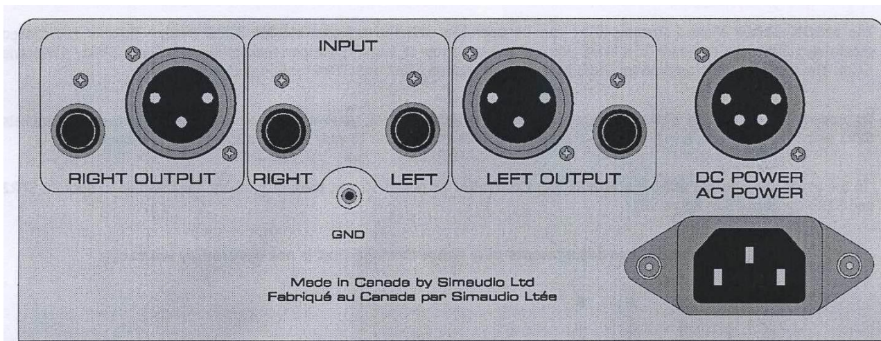
Рисунок 11: задняя панель фоно предусилителя “Moon 310LP”.
