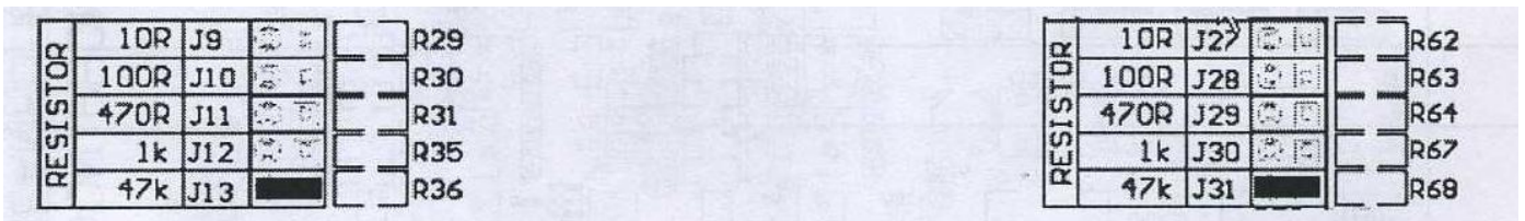
Рисунок 2: Разъемы переключателей для левого и правого канала при стандартных настройках нагрузочного сопротивления.
